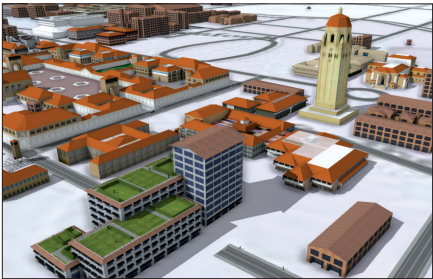
根据 Esri CityEngine 规则按程序生成的 3D 模型。
