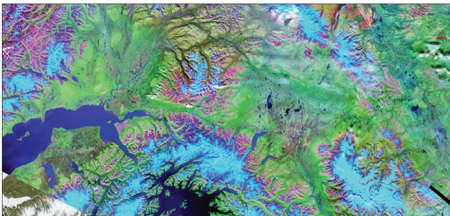
这个使用 MrSI 压缩交付的“全球土地覆被”镶嵌通过利用遥感卫星数据和产品来实现土地覆被变化和研究的可视化。MrSID 压缩可将影像数据大小减小至 20:1。然而，这也使压缩后的影像波段滞后于原始影像波段，同时去除了许多分析功能。
