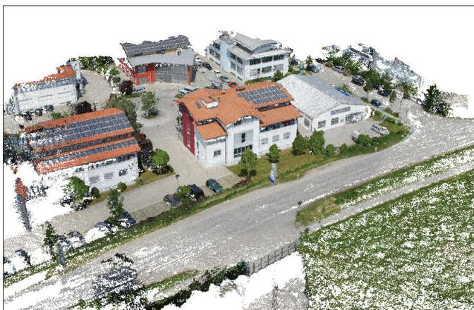
LAS 文件为行业标准格式，用于存储机载激光雷达数据。在这个渲染中，每个点都从源照片中分配了一个 RGB 值，产生了较为逼真的效果。
