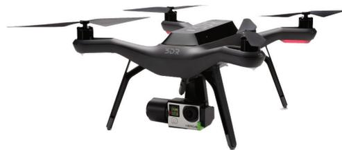
借助装备 Solo 相机的 3DR 四旋翼无人机捕获的高分辨率样本数据，您将能够创建一系列 2D 和 3D GIS 数据产品。
