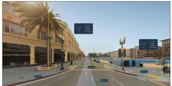
HERE Reality Lens 由高质量的街面全景视图和高精度的激光雷达数据作为支持，允许您针对街面数据执行准确的测量。
