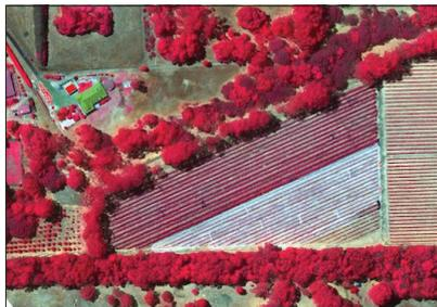
高级的、轻量级、多光谱相机为农业遥感应应用提供了精确的多波段数据。这意味着，超本地化无人机飞行可以很容易地识别农作物的受威胁区域 - 通过红色边过滤器（右侧）可见到的葡萄园上排的区域。
