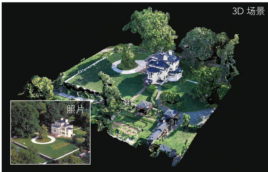
此 3D web 场景是由通过消费级私人无人机采集的点云生成的。无人机任务完成后，在不到 30 分钟的时间内即可在线完成此场景。
