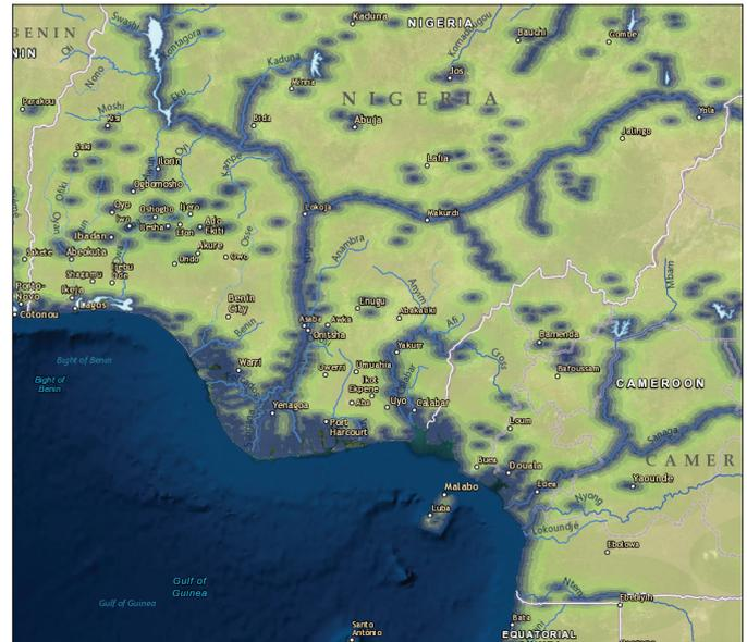
显示西非某区域中每个像元或像素到可靠水源的距离的邻域地图。水源对人类以及野生生物栖息地至关重要。溪流被叠加在距离格网上。格网中离水最近的像元为深蓝色。颜色随着与水距离的增加而逐渐变化。
