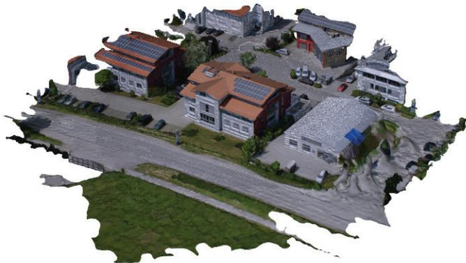
3D 网格是一组三角形或面连接在一起形成的所有点的集合。3D 网格可用于可导航 3D 场景。
