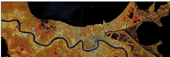
Landsat GLS Land 以及 Water Boundary（波段 4、5、3）突出显示了陆地与水体的边缘。
