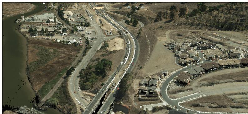
LAS 文件（通用激光雷达交换格式）是点的集合，每个点都具有水平坐标和垂直高程值。LAS 文件提供了存储附加信息（如激光强度、扫描角度和返回信息）的常用格式。将场景编码为红 - 绿 - 蓝 (RGB) 时看起来极为逼真，如此处的加利福尼亚州佩特卢马的可视化。
