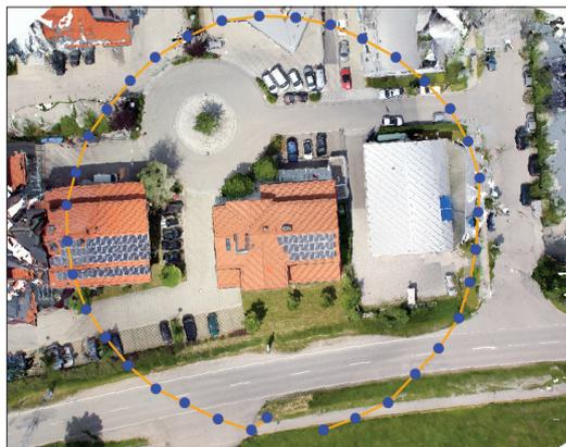
为了检查此建筑物，无人机飞行的路径近乎正圆（以黄色显示）。捕捉点为蓝点。
